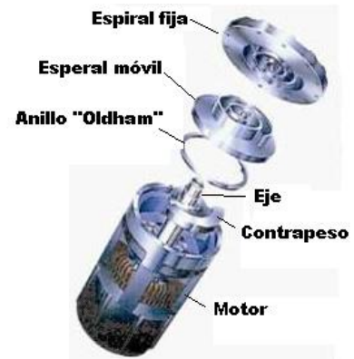
Figura 6 - Compresor scroll piezas básicas
